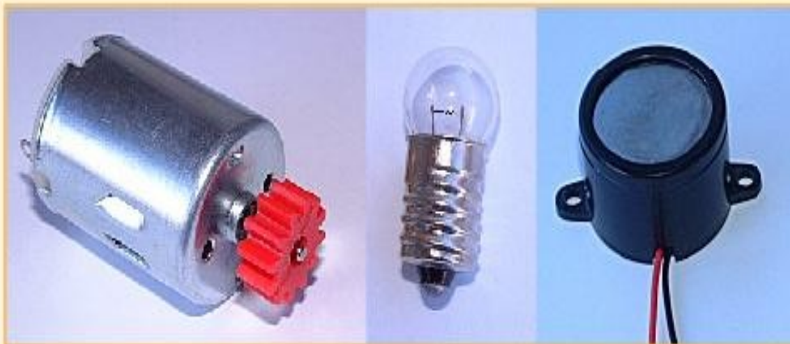
Receptores de un circuito eléctrico. De izquierda a derecha: motor eléctrico, bombilla y zumbador.
