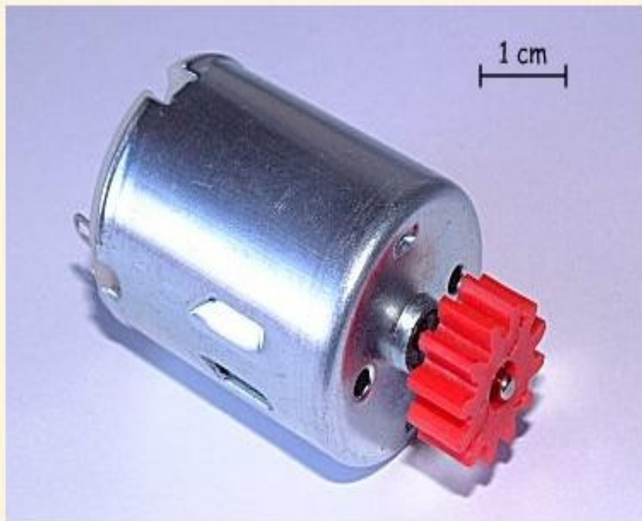
Motor eléctrico de 3-6 V con un engranaje de plástico añadido a su eje.
